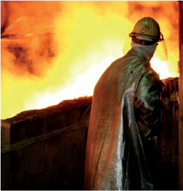
Der Metallabstich im Kayser Recycling System (KRS) in Lünen, in dem kupfer- und edelmetallhaltige Materialmische ausgedienter Elektro- und Elektronikprodukte geschmolzen werden. Beim Abstich wird der Verschluss des Schmelzofens geöffnet und so dem flüssigen, über 1.000° C heißen Metall das Auslaufen ermöglicht.
