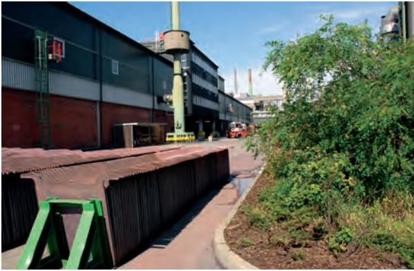
Es grünt wieder auf der Peute: Anoden warten frisch aus der Rohhütte gegossen darauf, in die Elektrolysebäder gehängt zu werden. Ohne die Umbauten und Restrukturierungen der 1980er Jahre gäbe es das Werk heute wahrscheinlich nicht mehr.
