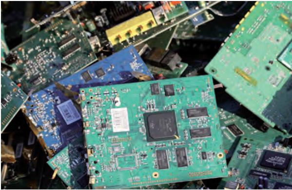
Elektronikschrott durchläuft erst eine Zerkleinerungsanlage und wird in Hamburg dann dem Konverterprozess der Rohhütte zugesetzt, in Lünen in den KRS chargiert. Die hohen Temperaturen der Konzentrat-schmelze zersetzen Fremdstoffe spontan und vollständig.
