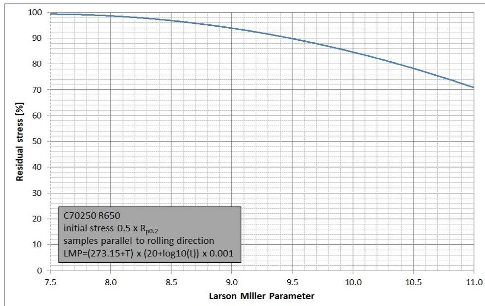
Relaxationsdaten von CuNi3SiMg als Restspannung über den Larson Miller Parameter aufgetragen. Der Larson Miller Parameter repräsentiert die Vergleichstemperatur und Testdauer. Test Methode: Mandrel Test entsprechend ASTM E328.
