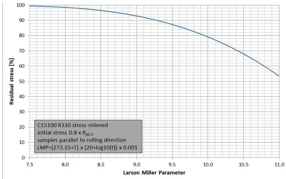
Die Relaxationsdaten werden als Restspannung über den Larson Miller Parameter aufgetragen. Der Larson Miller Parameter repräsentiert die Vergleichstemperatur und Testdauer.
