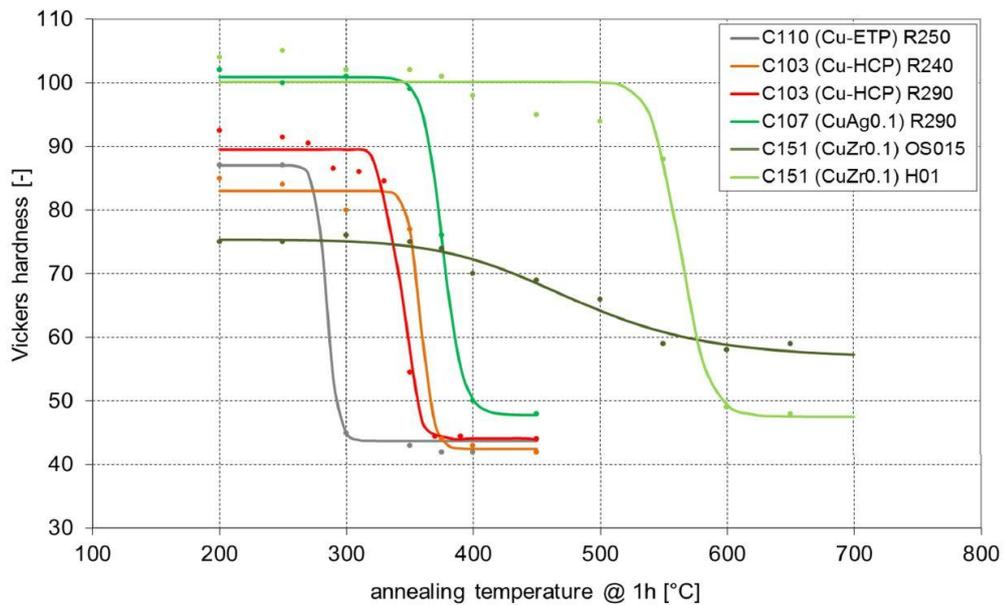
Dargestellt sind die Erweichungseigenschaften verschiedener Kupferlegierungen mit hoher Leitfähigkeit. CuZr0,1 hat eine sehr gute Beständigkeit gegen Erweichen. OS015 ist gegläht auf eine mittlere Korngröße von 15µm, H01 entspricht dem Zustand R280.
