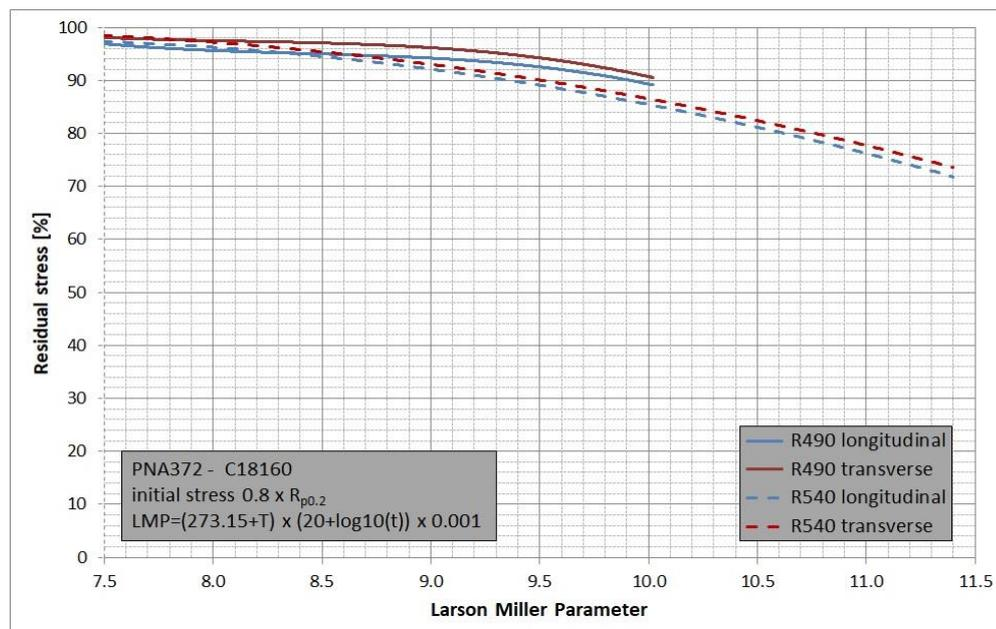
Relaxationsdaten von CuCrZr als Restspannung über den Larson Miller Parameter aufgetragen. Der Larson Miller Parameter repräsentiert die Vergleichstemperatur und Testdauer. Test Methode: Mandrel Test entsprechend ASTM E328.
